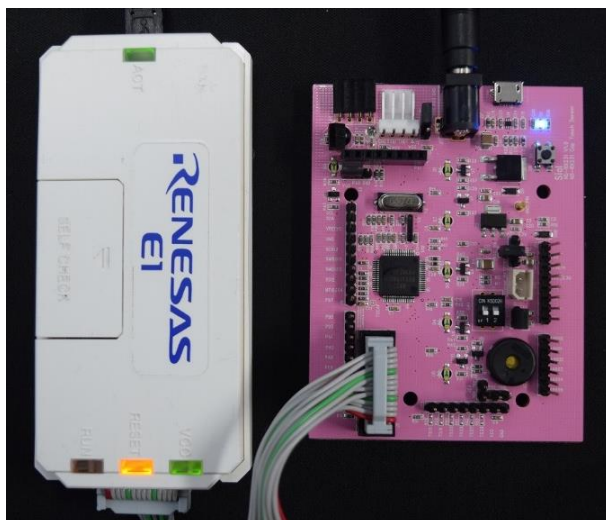
図 4-1 NS-RX231に電源アダプタとE1デバッグを接続した様子。
