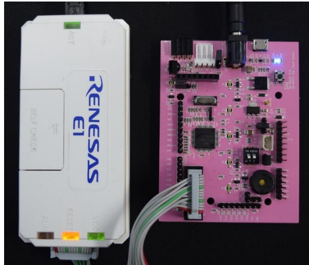
그림 4-1 NS-RX231을 전원 어댑터와 E1디버거를 연결한 모습.
