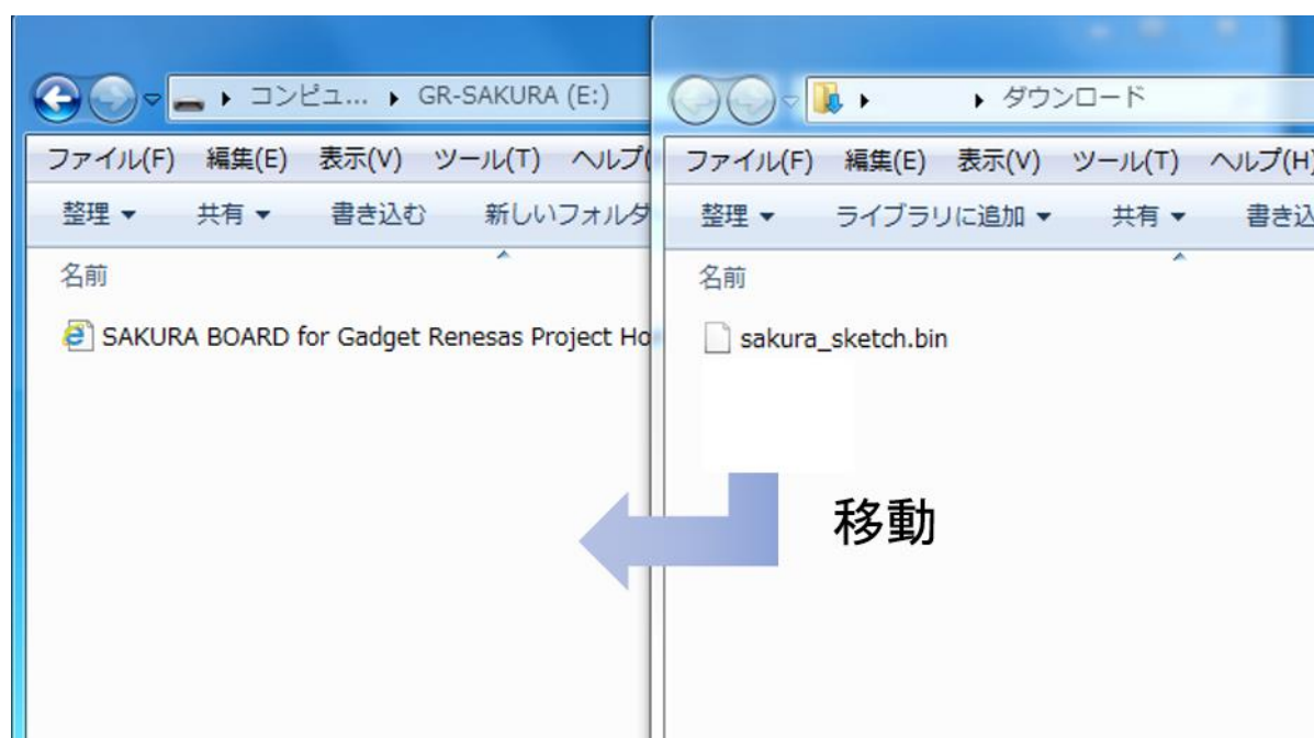
図 4-4 GR-SAKURAへのプロジェクトのダウンロード（書き込み）
